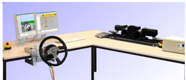
Bild 9 HiL-Prüfstand mit Fahrzeugmodell und Torque-Feedback-Lenkrad
